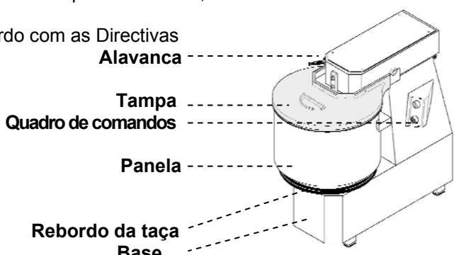
A possibilidade de extrair a panela permite a lavagem destas partes com água quente corrente ou na máquina de lavar louça.
