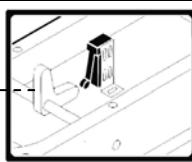
**Telerruptor:** en caso de ausencia de corriente accidental, requiere la reactivación voluntaria de la máquina
