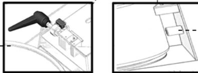
**Sensore:** non fa partire la macchina se non rileva la presenza della pentola (solo mod.CNS)
