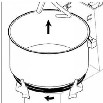
Para extraer la cubeta gire en el sentido de las agujas del reloj la brida inferior y levante la artesa hacia arriba (mod.CNS).
