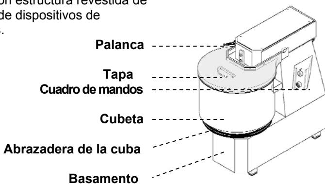
Se puede desmontar la cubeta, lo cual permite el lavado de esta pieza con agua corriente caliente o bien en el lavavajillas.
