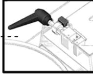
**Датчик:** не допускает запуск машины если не обнаружена дежа (только мод.) CNS)
