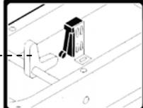
**Teleruptor:** em caso de interrupção accidental da corrente é necessário voltar a pôr a máquina a funcionar.
