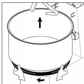
Pour extraire la cuve tourner la bride inférieure dans le sens des aiguilles d'une montre et soulever la cuve vers le haut (mod.CNS).
