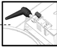
**Sensor:** no pone en marcha la máquina si no detecta la presencia de la cuba (solo mod. CNS)
