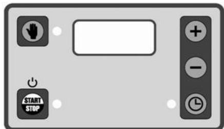
Если для работы не требуется таймер, нажать 2 раза подряд кнопку со значком руки (ручной режим), включится светодиод рядом с кнопкой (отключается таймер) и нажимая на кнопку "START/STOP", машина запускается в ручном режиме. После того, как закончен цикл, нажать на кнопку "START/STOP" и машина останавливается. Чтобы полностью включить дисплей, держать нажатой кнопку "START/STOP" около 3 секунд.
