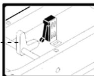
**Телевыключатель:** в случае случайного прерывания подачи тока, требует повторного запуска машины
