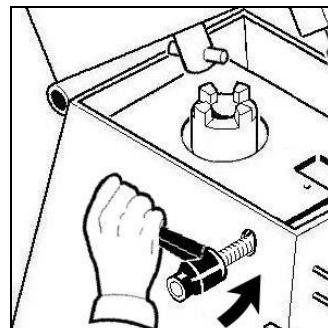
**И** **ИНФОРМАЦИИ:** Перед каждым циклом работы проверять, чтобы вынимаемые детали были закреплены плотно к машине. Закрыть кастрюлю, поворачивая против часовой стрелки нижний фланец.
