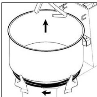
Para retirar a panela rode em sentido horário a flange inferior e puxe a panela para o alto (mod.CNS).
