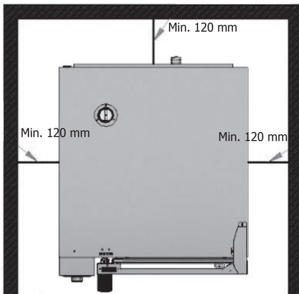
Esempio di collocazione dell'unità in prossimità di fonti di calore:
