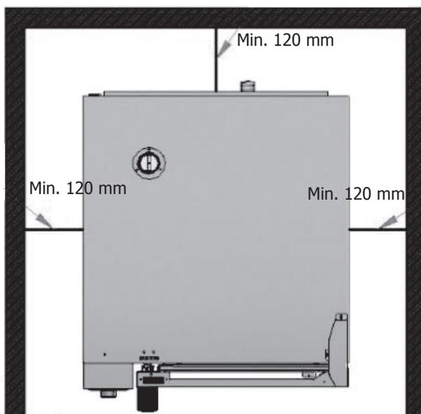
Beispiel für das Aufstellen des Geräts in der Nähe von Wärmequellen:
