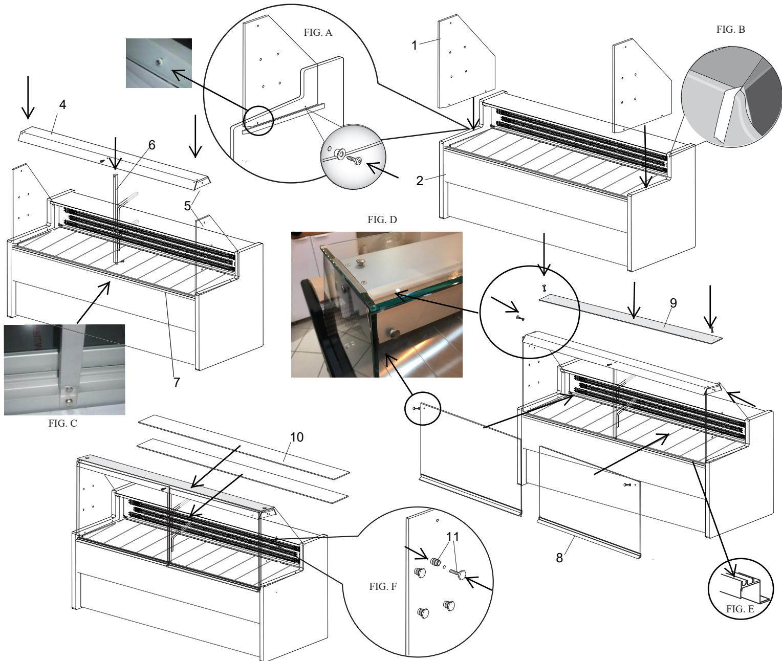
a) Dopo aver pulito il mobile in tutte le sue parti avendo seguito le istruzioni indicate nel manuale di installazione, iniziare il montaggio dei vetri. ATTENZIONE: durante tutta la pulizia del mobile utilizzare dei guanti da lavoro di categoria II a protezione delle mani.
